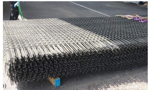
Figura 15. Mallas de armadura en base a barras de fibra de basalto.
