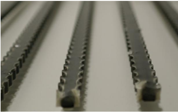
Figura 13. Barras corrugadas de fibra de basalto.
