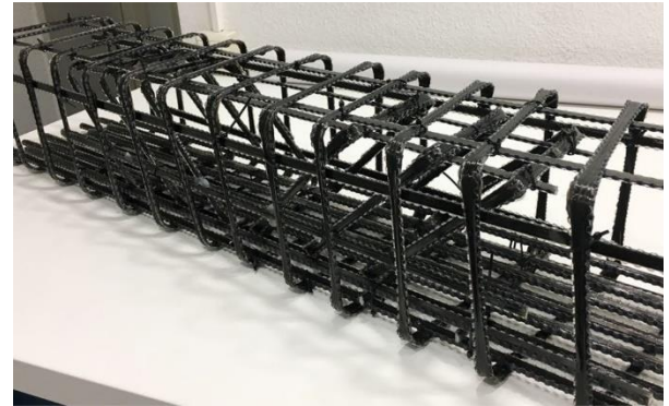
Figura 14. Jaula de armado con armadura en cercos en base a barras de fibra de basalto.
