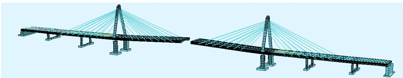
Figura 7. Modelo global para el proceso constructivo. Deformaciones afectadas de un factor de 10. (LAP)
