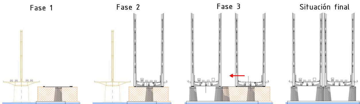
Figura 15. Proceso constructivo: ripado transversal del puente completo (LAP).
