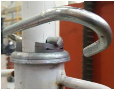
Figura 4. Resultados del ensayo de laboratorio y detalle del limitador de carga tras la finalización de uno de los ensayos.
