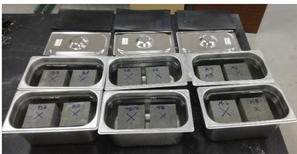
Figura 4. Ensayo de hielo-deshielo.
