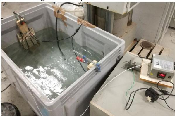
Figura 5. Baño a 25°C para el ensayo de hielo-deshielo.
