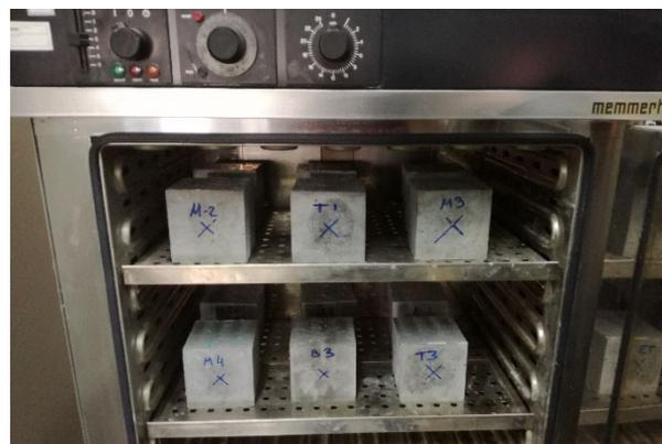
Figura 7. Probetas en estufa, ensayo choque térmico. Resultados
