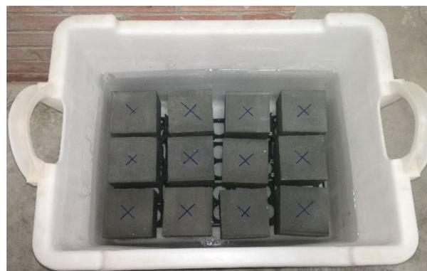
Figura 6. Probetas inmersas en agua, ensayo choque térmico.
