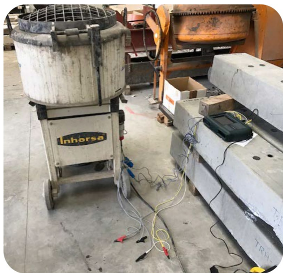
Figura 6. Hormigonera instrumentada para medida de Potencia.
