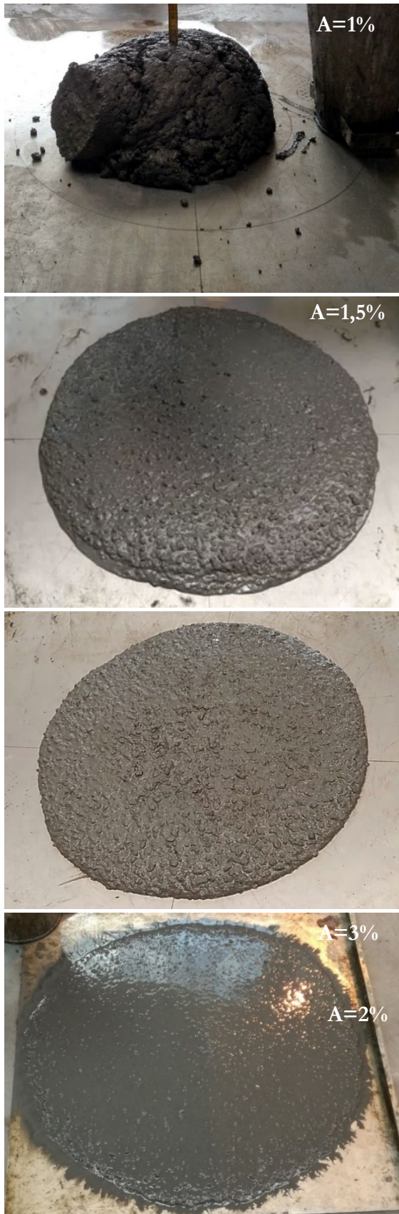
Figura 10. Ensayo de escurrimiento, Aspecto final.
