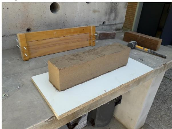
La tierra utilizada se ha mezclado en proporciones 3:1 y 4:1 con cal, utilizada como conglomerante. Se evita el uso de cementos por los problemas de incompatibilidad molecular con las arcillas y por alejarnos de soluciones y
