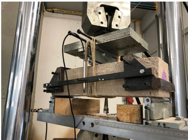
Figura 7. Ensayo a flexión en tres puntos.
