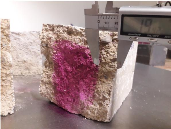
Figura 3. Medida del frente carbonatado.
