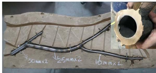
Figura 8. Fabricación de ramas y sección resultante.
