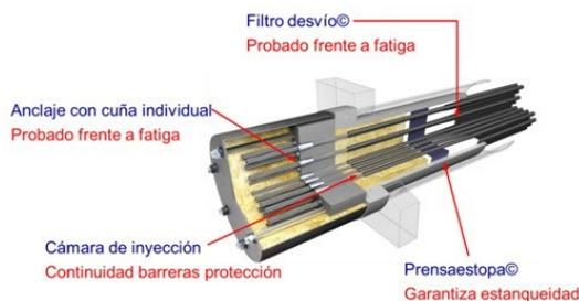
El propio anclaje limita la desviación angular guiando individualmente cada cordón con un radio preconcebido, independientemente del ángulo global, y garantizando que el cordón entra ortogonalmente en el bloque de anclaje y no daña ningún otro elemento. En particular, evita que las vibraciones alcancen la zona de cuñas.
