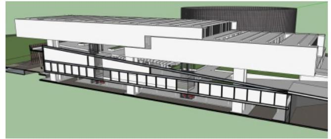
Figura 10. Esquema estructural del volumen suspendido
