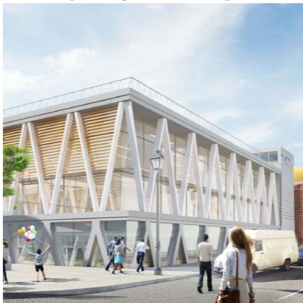
Figura 4. Pilares inclinados en la fachada estructural
