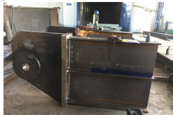
Figura 8. Ejecución en taller de ménsula embebida en cimentación y de la chapa para conectar la pila articulada
