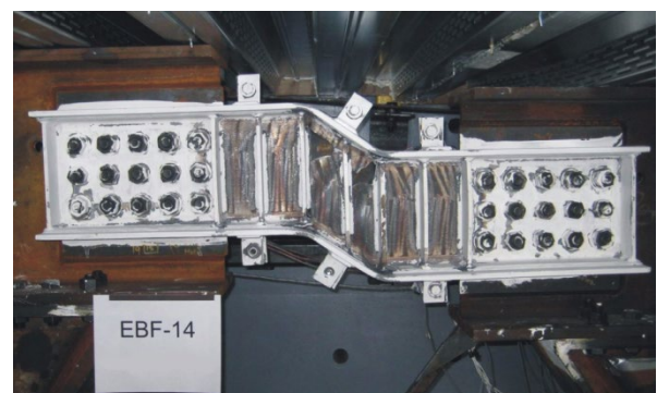
Figura 5. Formación de rótula en un EBF según ensayos de Mansour [3]
