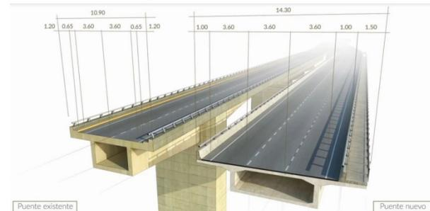
**Figura 3. Comparativa de las secciones transversales del puente existente y del nuevo puente**
