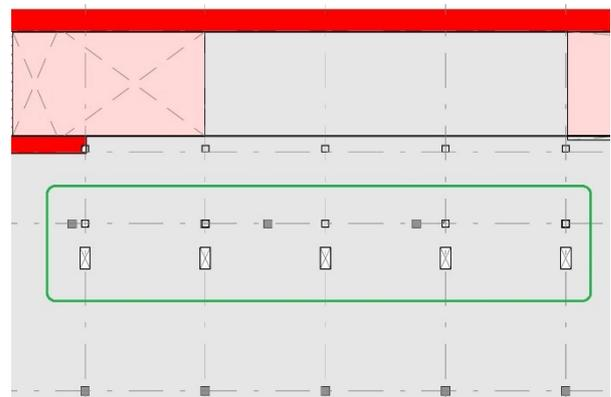
La proximidad de estos tramos a las estructuras existentes añadió en algún caso una dificultad adicional (ver Figura 4) consistente en tener que realizar la transición en planta con el mínimo desarrollo posible para no exceder los límites de anchura prefijados para la banda de tendones, y a la vez no emplear radios de curvado (combinando ambas curvaturas, la de alzado y la de planta) que fueran inferiores al mínimo admitido por la vaina.
