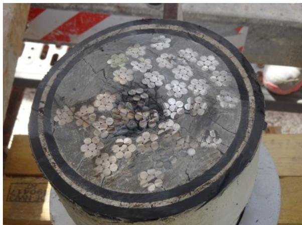
Los anclajes, tanto los activos situados en el pilono, como los pasivos, en el tablero, están inyectados con resina. Estos elementos son accesibles (los superiores desde el exterior del pilono y los inferiores desde el interior del cajón) pero no así el tramo de tirante próximo a los mismos, por encontrarse la vaina de los mismos embebida en el hormigón de torre o tablero.
