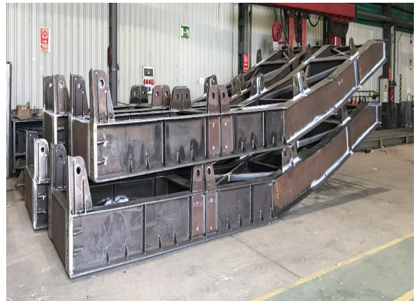
Figura 9. MEF. Premontaje de cordones en taller.
