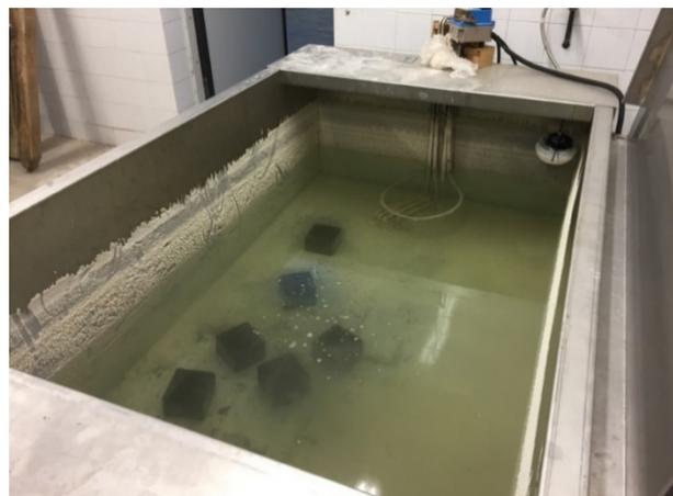
Figura 2. Enfriamiento en agua de las probetas.
