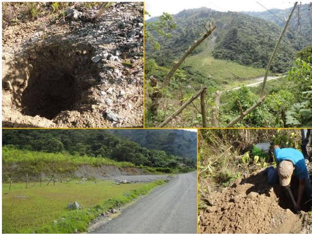
Fotografía 2. Toma de muestras para la viabilidad de los áridos locales. Hormigón J.
