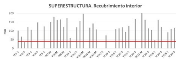
Fig. 4. Recubrimiento y límite exigido en proyecto. Paramento interior.
