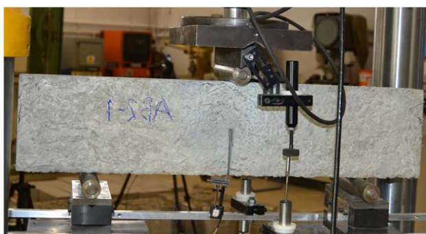
Figura 2. Probeta preparada para ser ensayada a flexión en tres puntos.
