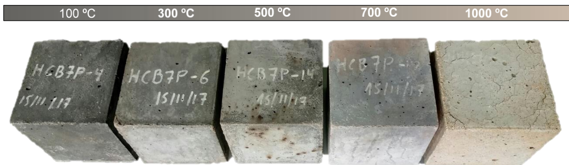
Figura 5. Aspecto visual de las probetas sometidas a altas temperaturas.
