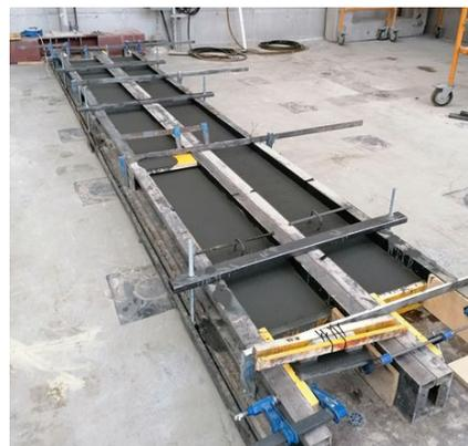
Figura 14 Vigas de HMAR de 4.50m
