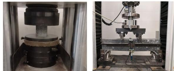
**Figura 5 Ensayo a compresión (izq.) y a flexión a cuatro puntos (der.).**
