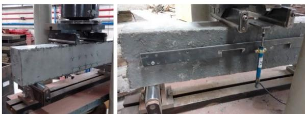
**Figura 3 Disposición del ensayo a cuatro puntos**
