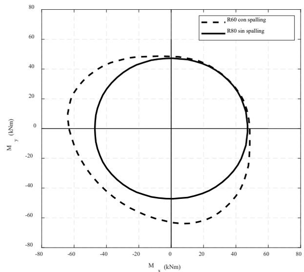
Figura 10. Diagrama de interacción R60  $\mu= 0.4$
