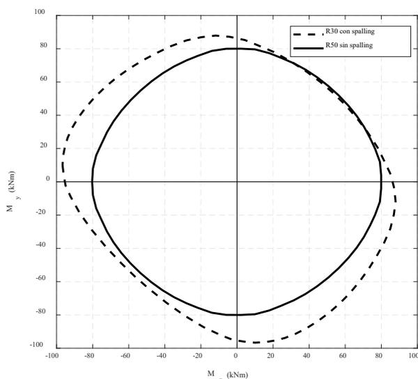
Figura 9. Diagrama de interacción R30  $\mu= 0.4$
