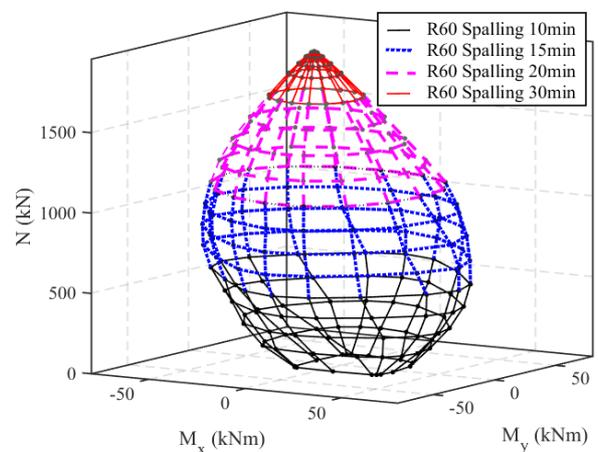
Figura 8. Superposición de las superficies de interacción para R60
