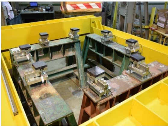
Fig. 5. Sistema de apoyos sobre células de carga.
