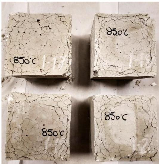
Figura 6. Fisuración exterior en el NAC (A0) tras exposición a 850 °C.
