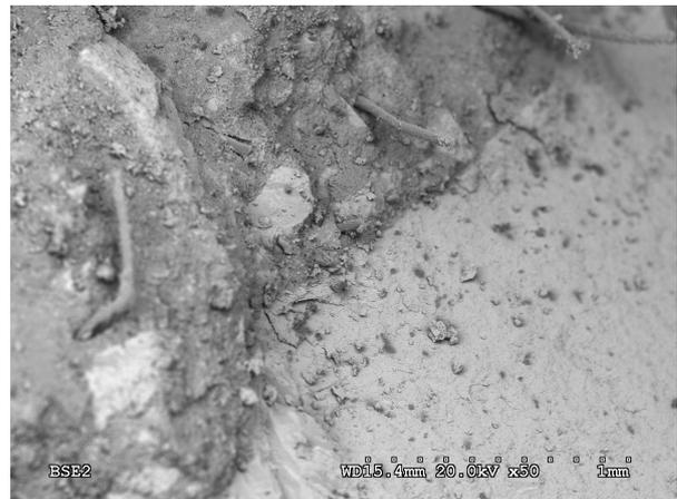
Figura 12. Fotografía SEM de A0 a 20 °C a 50 aumentos, con detalle de fibras de polipropileno.
