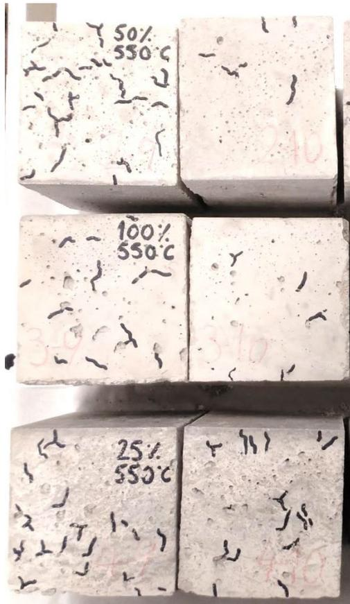
Figura 7. Fisuración exterior en los RAC tras exposición a 550 °C.
