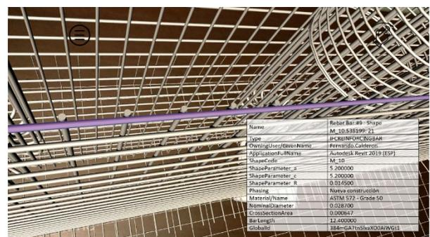
Figura 11. Información BIM de una barra
