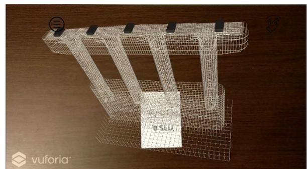
Figura 10. Armadura de la pila aislada
