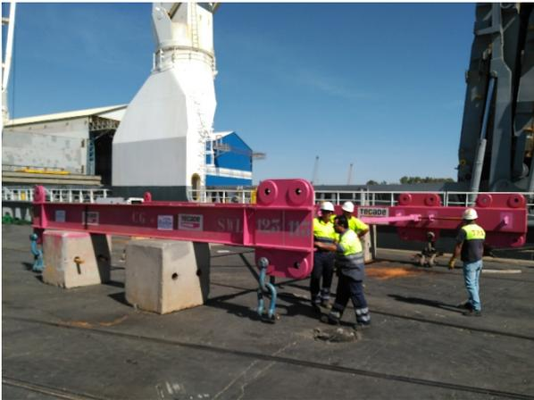
Figura 26. Dos separadores de cables desarrollados para la elevación con una o dos grúas, con los brazos de posicionamiento.
