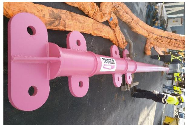
**Figura 22.** Unos de los separadores de cables diseñados, con 4 posiciones distintas de uso, de 15 m de largo.
