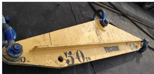
Figura 14. Pescante fabricado para las maniobras.
