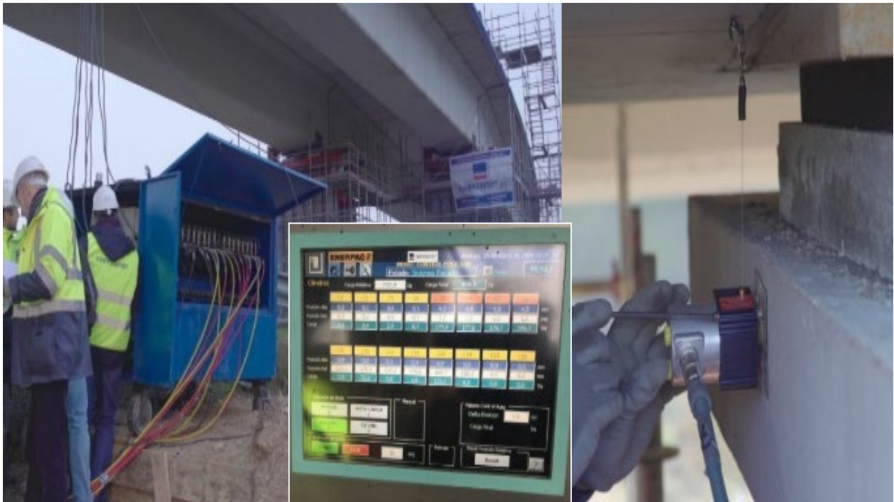
Figura 9. Vista del FREYSSILAO® y pantalla digital de control y vista sensor vertical de desplazamiento.
