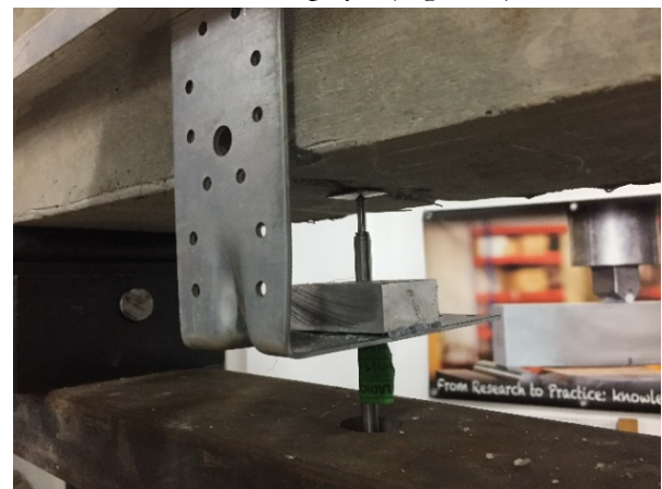
Figura 2. Detalle de la colocación del LVDT.
