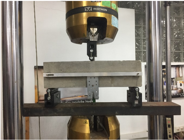
Figura 3. Colocación de la probeta en la máquina de ensayo.
