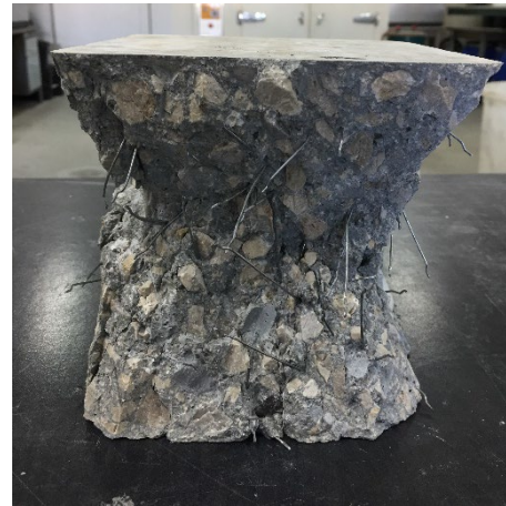
Figura 4. Probeta ensayada a compresión.
