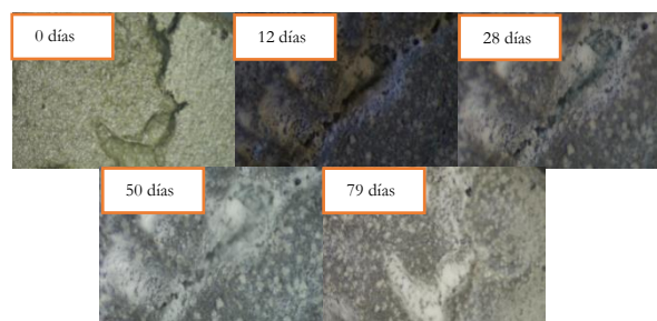
Figura 7. Imágenes de una fisura de morteros con MSS(6%) a la edad de 79 días
