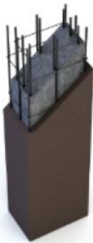
Figura 5: Renderizado del aumento de sección diseñado
